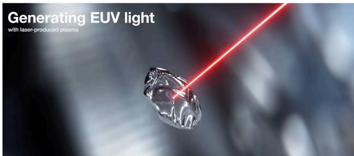
Simulare a unei secvențe din procesul de producție – lovirea unei particule de staniu cu o rază laser.
